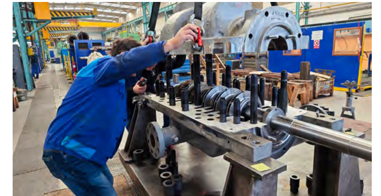
2 Montáž čerpadla před funkční zkouškou
