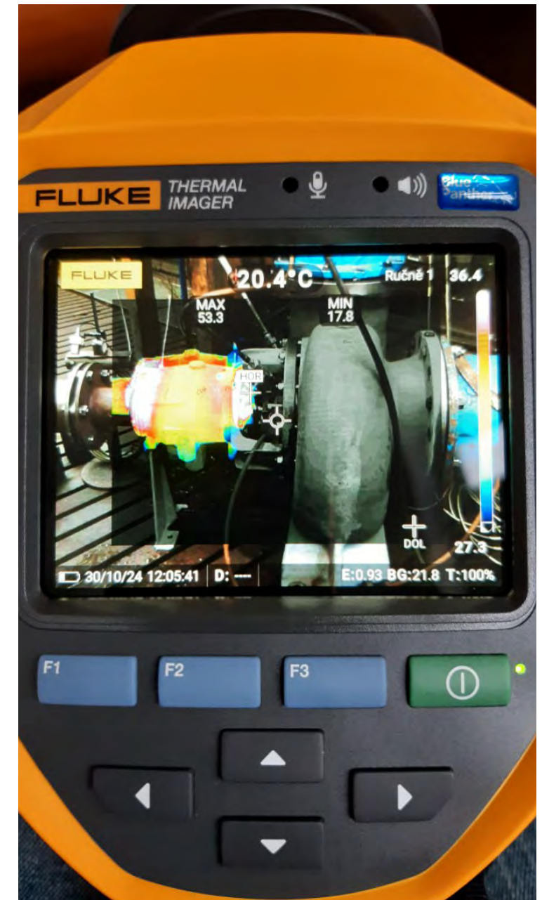
3 Pohled na LCD obrazovku, teplota povrchu čerpadla 300-KIDH-390.
