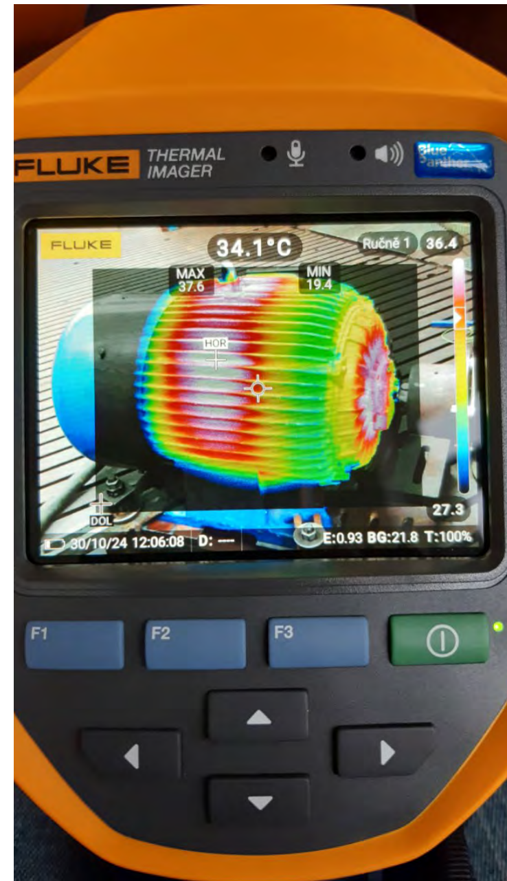
2 Pohled na LCD obrazovku, teplota povrchu elektromotoru Celma 110 kW.
